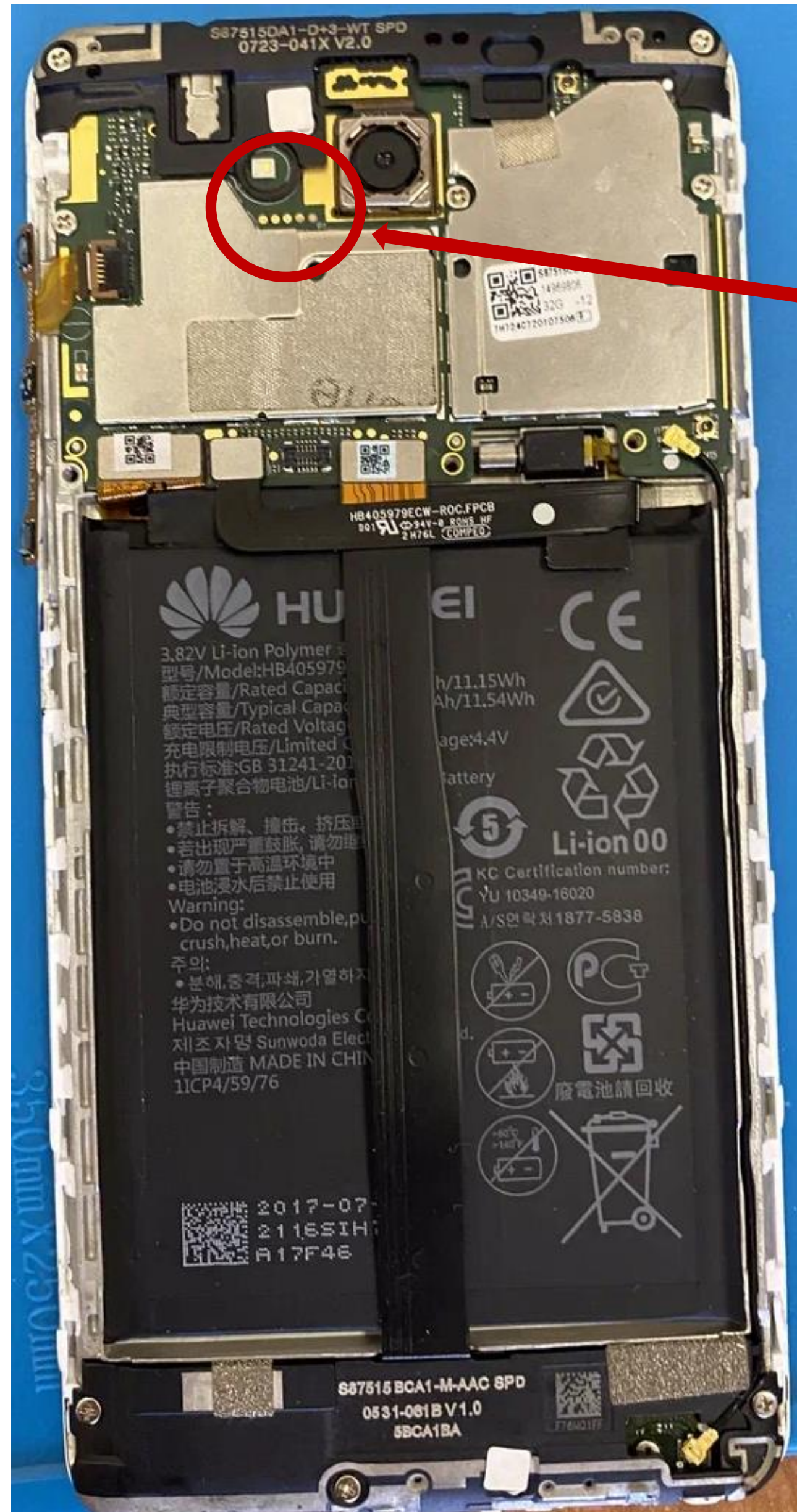
2 Контактные точки для перевода в режим EDL устройства Honor 6C
